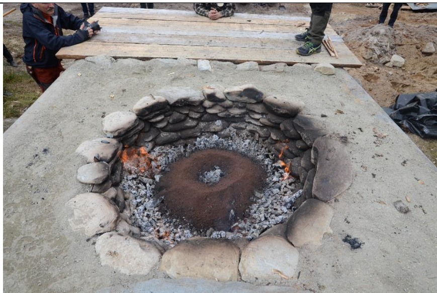
Første påkast av malm på glødene kull
