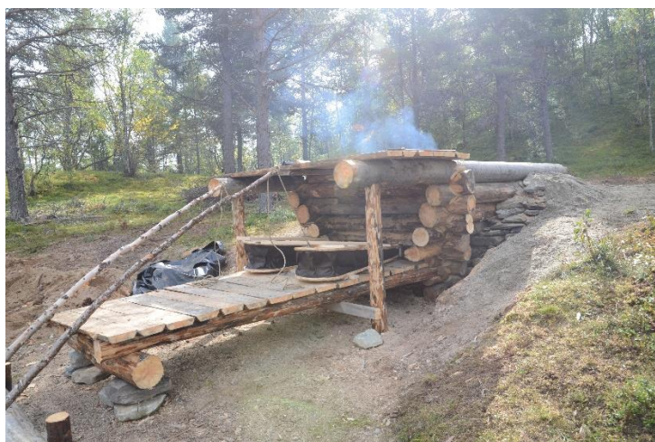
Ovnen er ferdig og prøvefyres, belgene i forkant
